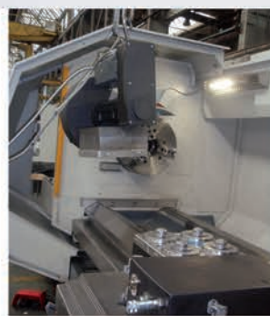
▲ System „Power-Grip” z wymiennymi paletami do szybkiej zmiany systemu narzędziowego
