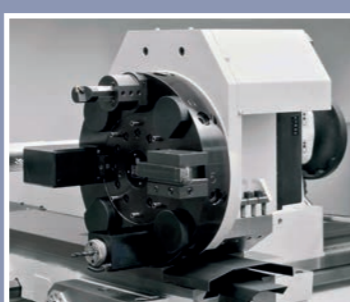
Głowica rewolwerowa z napędzanymi narzędziami wraz z osią C
