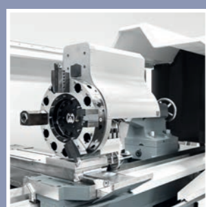
Głowica rewolwerowa z napędzanymi narzędziami wraz z osią C
