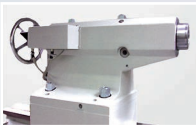
Pinola sterowana manualnie w połączeniu z hydrauliką
