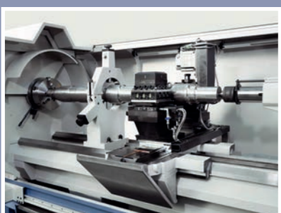
Głowica rewolwerowa oraz przystawka frezarska po przeciwnej stronie osi toczenia
