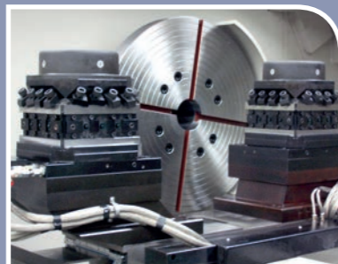
2 głowice 4-pozycyjne w układzie tandem
