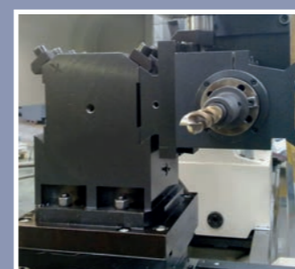
Głowica frezarsko-wiertarska montowana na głowicy narzędziowej
