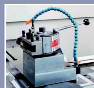
Standardowy imak narzędziowy Multifix D1
