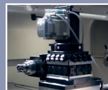
Głowica frezarsko-wiertarska montowana na głowicy narzędziowej
