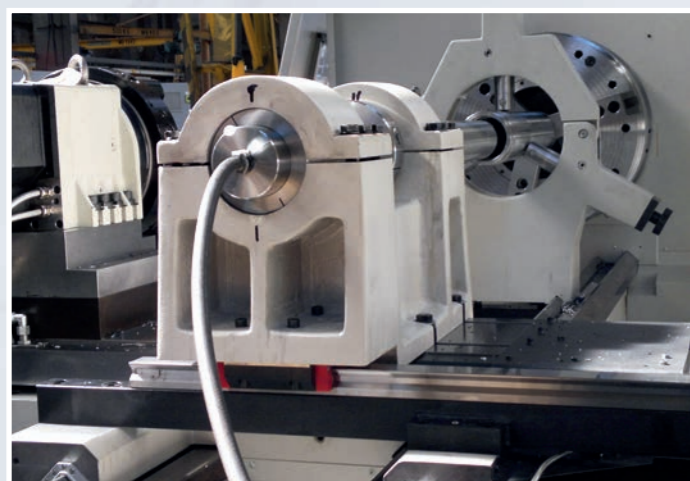
Przystawka do głębokiego wytaczania montowana na suportcie
