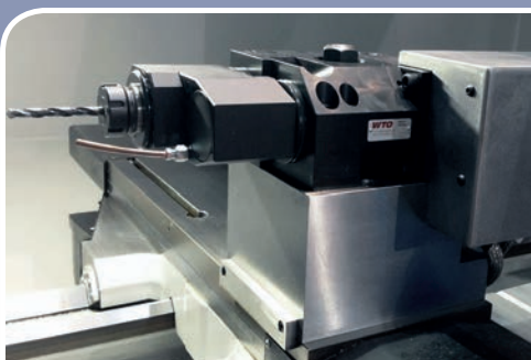
▲ System narzędziowy WTO do toczenia, wiercenia i frezowania
