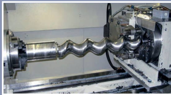
▲ Instalacja oraz przystosowanie agregatu wielonarzędziowego
