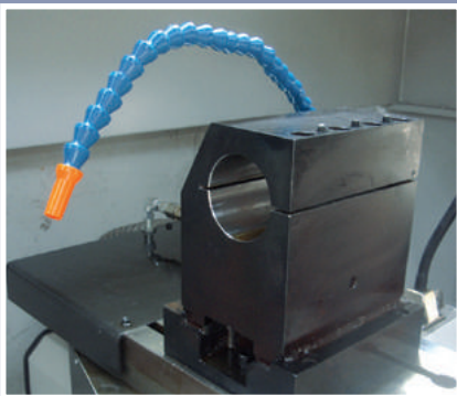
▲ Przystawka do głębokiego wytaczania montowana na suportcie
